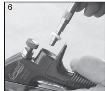
6. Retire el asiento de la válvula.
