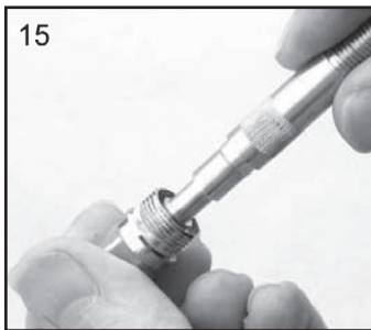
15. Coloque la junta en el alojamiento (10).
