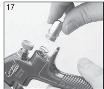
17. Vuelva a colocar el muelle de la válvula y el tornillo en el alojamiento (10).
