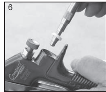
6. Retire el asiento de la válvula.
