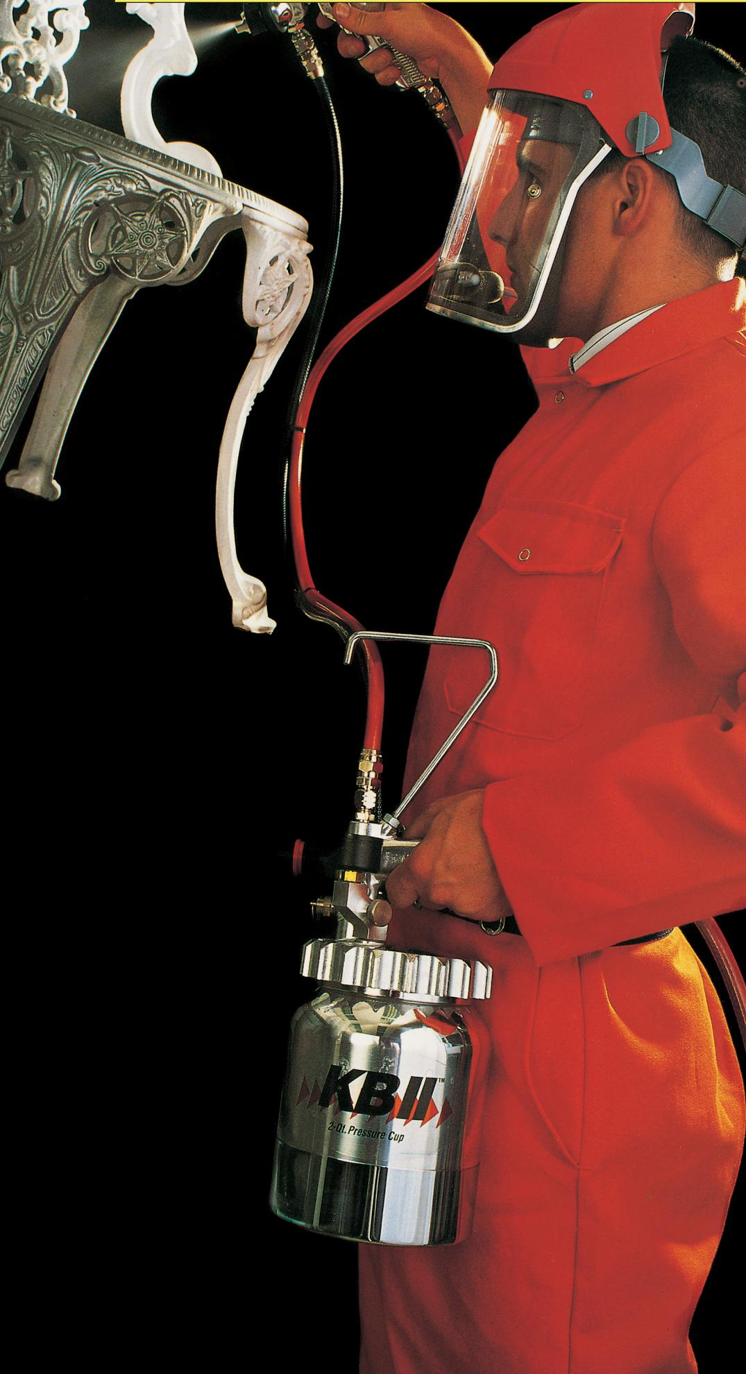
Permite máxima libertad de movimiento de la pistola para nebulizar los puntos más difíciles de alcanzar.
